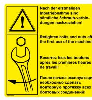
Inbetriebnahme sind D sämtliche Schraub-verbindungen nachzuziehen! Retighten bolts and nuts after GB the first use of the machine! Reserrez tous les boulons après les premières heures F После начала эксплуатации необходимо сделать
