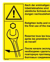
Inbetriebnahme sind D sämtliche Schraub-verbindungen nachzuziehen! Retighten bolts and nuts after GB the first use of the machine! Reserrez tous les boulons après les premières heures F После начала эксплуатации необходимо сделать повторную протяжку всех болтовых соединений! RU
