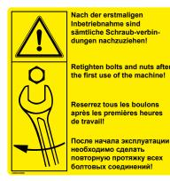
Inbetriebnahme sind D After the sämtliche Schraub-verbindungen nachzuziehen! commissioning, connections screw Retighten bolts and nuts after GB must be tightened! the first use of the machine! Reserrez tous les boulons après les premières heures F
